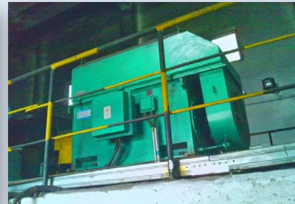
Двигатель для удаления коксовой пыли
